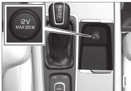
12 V strømuttak i tunnelkonsoll, forsete.
