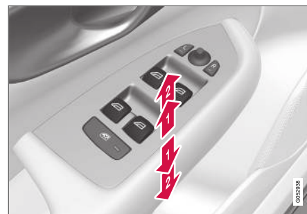
Regulering av vindusheiser.
