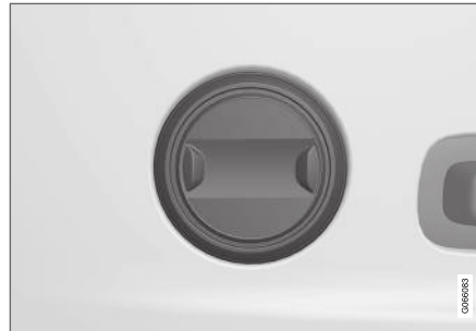
Bryteren i biler med toveis korsryggstøtte*.
