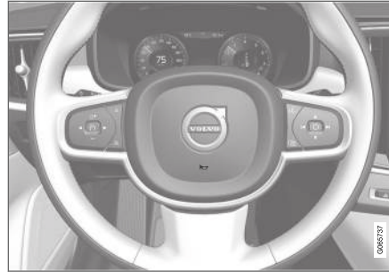
Signalhornet är placerat på rattens centrum.
