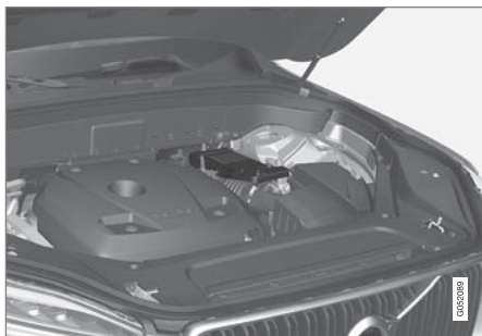
แบตเตอรี่เสริมจะอยู่ในช่องถัดจากเหล็กค้ำใช้
