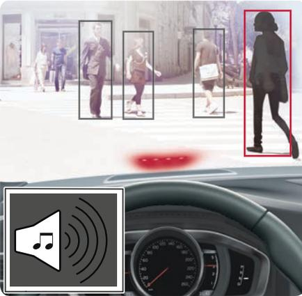
Das Fahrzeug verfügt über ein Unfallwarnsystem mit Bremsautomatik sowie Fußgänger- und Radfahrererkennung, das vor Fahrzeugen, Radfahrern und Fußgängern warnen sowie das Fahrzeug abbremsen und/oder zum Stehen bringen kann.
