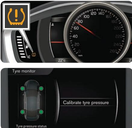
Eine Kalibrierung muss nach jedem Reifenwechsel und nach jeder Änderung des Reifendrucks durchgeführt werden. Wenn das Symbol (⚠) aufleuchtet, muss der Reifendruck kontrolliert und das System kalibriert werden. Gehen Sie dazu wie folgt vor:
