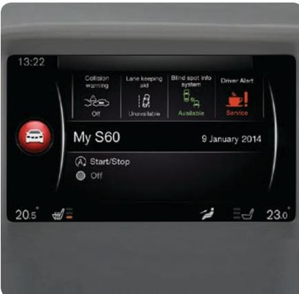
In **MY CAR** werden viele Funktionen des Fahrzeugs bedient, z. B. Einstellungen zu Uhr, Außenspiegeln und Verriegelung.
