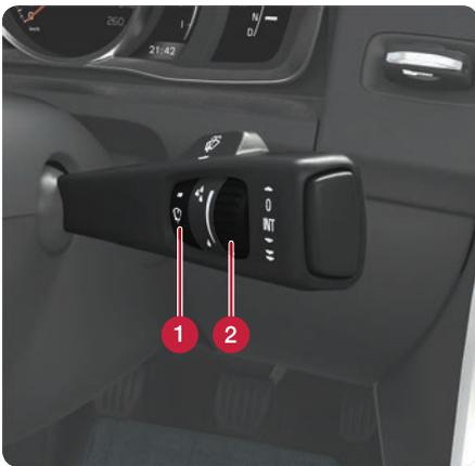
Hebel nach unten drücken, um die Scheibenwischer einzuschalten, und nach oben, um einzelne Wischbewegungen durchzuführen.
