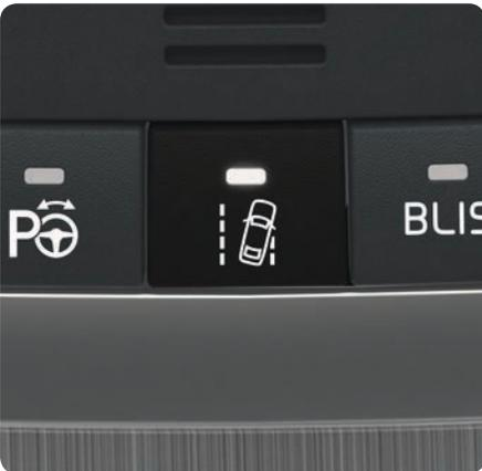
Wenn das Fahrzeug im Begriff ist, einen Seitenstreifen zu überfahren, wird der LKA aktiv eingreifen und durch einen schwaches Andrehen des Lenkrads auf die Fahrbahn zurücksteuern. Wenn das Fahrzeug einen Seitenstreifen überfährt, wird der LKA eine Warnung mit pulsierenden Vibrationen im Lenkrad ausgeben.
