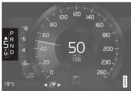
Växlingsindikator i 8-tums förardisplay för stor växelspak.
