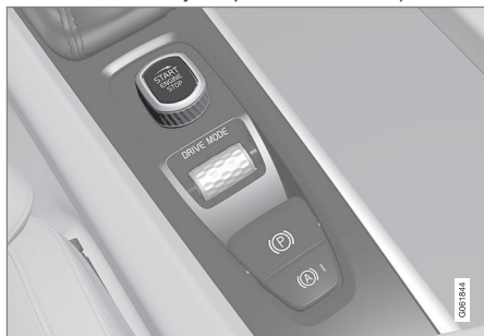
Startvredet i tunnelkonsolen.
