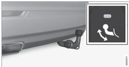
將拖車桿移動至末端位置，拖車桿在此會固定並鎖住 - 指示燈恆亮橘光。
