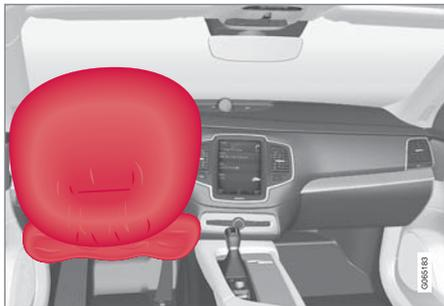
前座駕駛側的方向盤防護氣囊及膝部防護氣囊。
