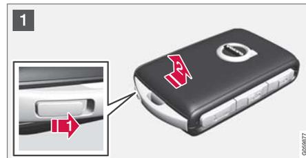
1 握住遙控鑰匙，露出正面，使 Volvo 標誌面對右側。將底緣處鑰匙圈旁的操作鈕滑向右邊。將前側殼體向上推幾公釐。
