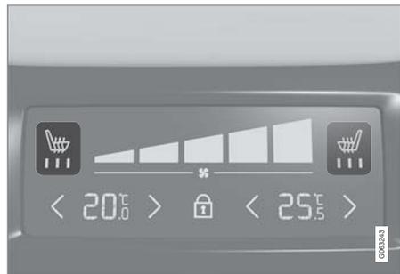
前座中央扶手後方恆溫控制面板上的座椅加熱指示與控制裝置。
