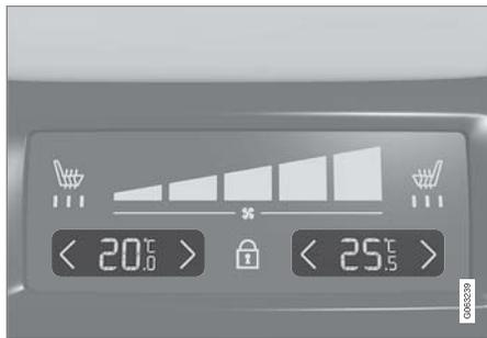
前座中央扶手後方恆溫控制面板上的溫度控制裝置。
