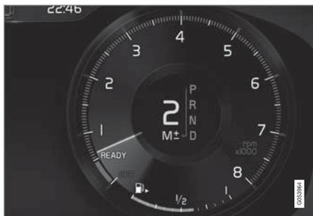
駕駛人顯示器當於手排模式下以方向盤撥片換檔時。
