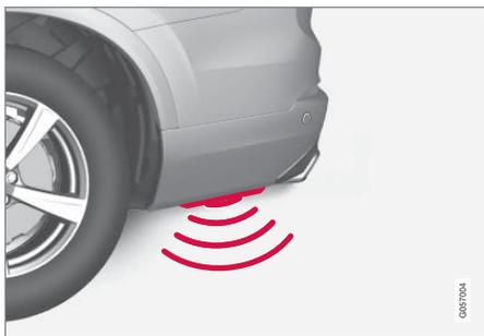
若要對配備底盤護板的車輛進行腳部動作啟閉操作，要在車輛的側邊進行踢腳動作。車輛的一把遙控鑰匙必須位於一定範圍內（約 1 公尺（3 呎）），才能夠進行啟閉。
