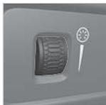
方向盤左側的儀錶板上的撥轉輪用於調整顯示器燈、控制燈、環境燈及氣氛燈\*的亮度
