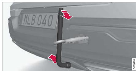
將拖車環鎖緊。例如, 穿過輪圈螺栓扳手\* 並以其為槓桿。
