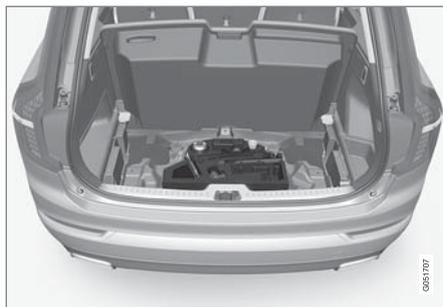
行李廂地板下的發泡磚容納車輛的拖鉤環、爆胎修理工具組、用來拆卸輪圈螺栓上塑膠蓋的工具以及可鎖輪圈螺栓的托座。
