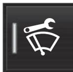
壓下設定擋風玻璃 雨刷維修模式按鈕。當保養模式啟用時，按鈕中的指示燈會亮起。啟用時，雨刷會自行定位為直立姿勢。要停用保養模式，請再次按下設定擋風玻璃 雨刷維修模式。當保養模式關閉時，按鈕中的指示燈會熄滅。
