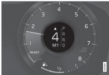
12 吋駕駛人顯示器\*中的換檔指示器。
