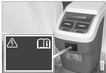
第二排座椅中央扶手控制台中的電源插座。
