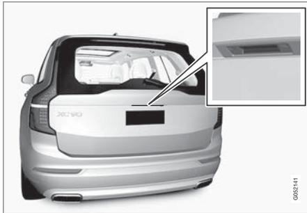
尾門上的橡膠壓板只能用於開鎖。
