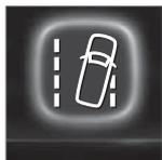
駕駛人顯示器中的這個符號顯示 LKA 已啟動，且持續檢查駕駛人是否將雙手放在方向盤上。
