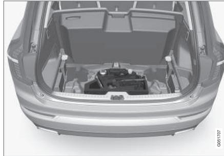
Il blocco in schiuma sotto il pavimento nel bagagliaio contiene occhiello di traino, kit di riparazione pneumatici, attrezzo di rimozione dei cappucci in plastica dei dadi delle ruote, martinetto\* e chiave per i dadi delle ruote\*. Qui è riposta anche la chiave per i dadi delle ruote antifurto.
