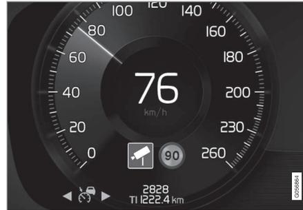
Avvertimento autovelox sul display del conducente.
