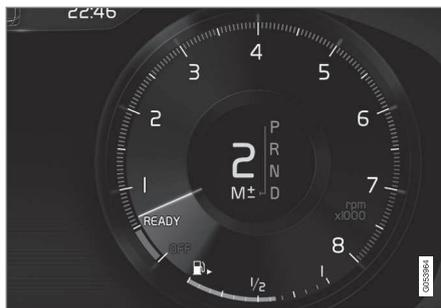
Modalità di cambio marce manuale nel display del conducente<sup>2</sup>.
