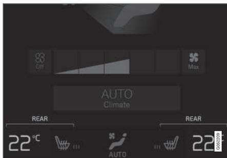
Pulsanti di temperatura nella scheda **Climatizzatore posteriore** della videata climatizzatore.
