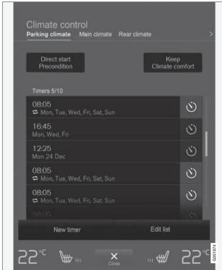
Precondizionamento e funzione che mantiene l'abitacolo confortevole si gestiscono dalla scheda **Climatizzatore parcheggio** della videata climatizzatore sul display centrale.
