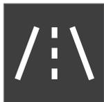
Il mantenimento corsia attivo è visualizzato con un simbolo sul display del conducente per le varie situazioni.
