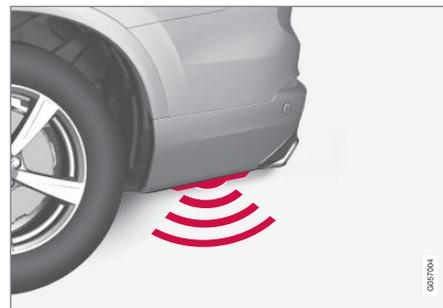
Se l'automobile è dotata dell'accessorio skid plate/diffusore\*, il sensore si trova nell'angolo sinistro del paraurti.
