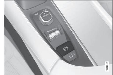
Il comando del freno di stazionamento si trova nel tunnel fra i sedili.
