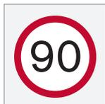
L'avvertimento di velocità è rappresentato dal lampeggio del simbolo del limite di velocità sul display del conducente per tutto il tempo in cui detta velocità è superata.
