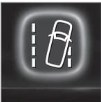
In caso contrario, il display del conducente visualizzerà un simbolo e il messaggio **Assistenza per corsia Sterza** che esorta il conducente a sterzare attivamente l'automobile.
