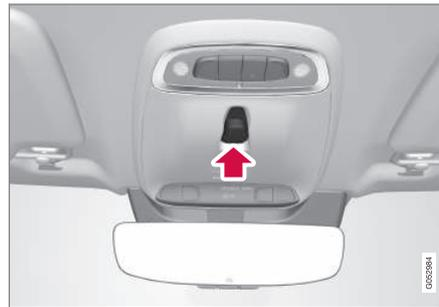
Il tettuccio panoramico e la tendina si azionano con un comando nel padiglione. Il comando si attiva quando il quadro dell'automobile è in posizione **I** o **II**.
