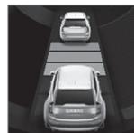
È possibile selezionare diverse distanze temporali dal veicolo antistante, che vengono visualizzate sul display del conducente con 1-5 linee orizzontali - più linee sono visualizzate, maggiore è la distanza temporale.
