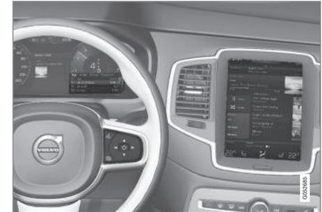
Al posto del display centrale si può utilizzare il menu app sul display del conducente.
