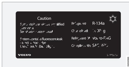
3 Etichetta sulle automobili dotate di climatizzatore contenente refrigerante R134a.
