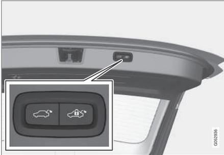
Pulsante di chiusura e bloccaggio sul bordo inferiore del portellone.
