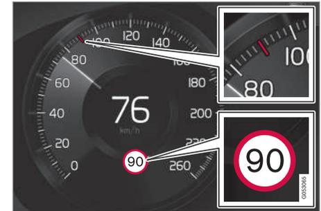
Esempio di informazioni sulla velocità rilevate<sup>4</sup>.
