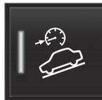
Le automobili senza comando della modalità di guida sono dotate di un pulsante funzione di marcia a bassa velocità con **Hill Descent Control** nella videata funzioni sul display centrale.
