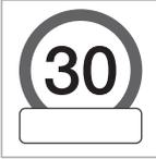
La visualizzazione di un cartello accessorio sotto forma di un riquadro vuoto sotto il segnale di velocità sul display del conducente indica che la funzione RSI ha rilevato un cartello accessorio con informazioni
