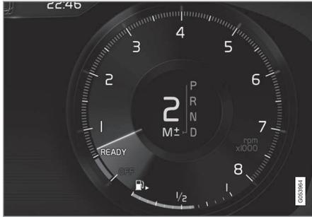
Display del conducente in caso di cambio marce con le palette al volante in modalità di cambio manuale.
