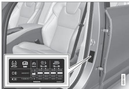
L'etichetta pressione pneumatici sul montante della portiera del conducente (tra portiera anteriore e posteriore) indica le pressioni dei pneumatici richieste in base al carico e alla velocità.
