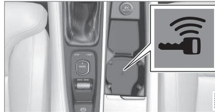
Posizione del lettore di riserva nel tunnel.
