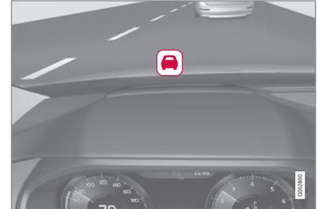
Un simbolo lampeggiante cattura l'attenzione del conducente.
