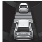
È possibile selezionare diverse distanze temporali dal veicolo antistante, che vengono visualizzate sul display del conducente con 1-5 linee orizzontali - più linee sono visualizzate, maggiore è la distanza tempo-
