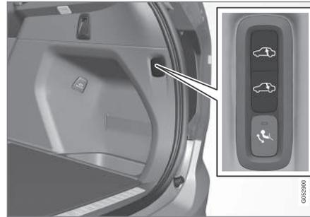
Utilizzare i pulsanti nel bagagliaio per regolare l'altezza del retrotreno e agevolare carico e scarico o le operazioni di aggancio/sgancio di un rimorchio. Vedere la sezione "Carico".
