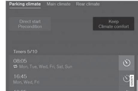
Pulsante della funzione che mantiene l'abitacolo confortevole nella scheda **Climatizzatore parcheggio** della videata climatizzatore.
