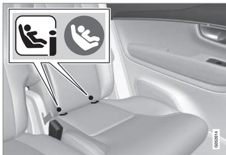
La posizione dei punti di fissaggio è indicata da simboli<sup>4</sup> sul rivestimento dello schienale.
