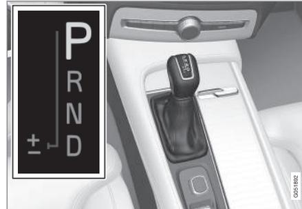
Il display del conducente visualizza la posizione della leva selettoria:
