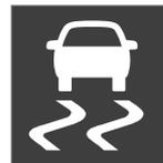
In sede di frenata, l'intervento del sistema ESC può essere percepito come un suono pulsante. In sede di accelerazione, l'automobile può rispondere più lentamente del normale.
