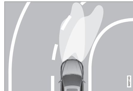
Fascio di luce con funzione disattivata (sinistra) o attivata (destra).
