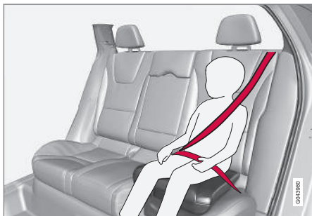
Posizione corretta: la cintura deve trovarsi sul lato interno della spalla.
