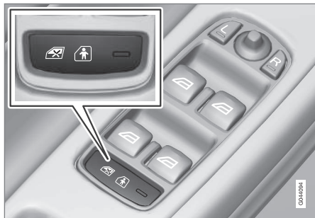
Panel de comando da porta do condutor.
