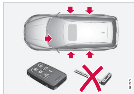
Fechaduras activas do comando à distância sem parte da chave e trancagem de privacidade activada .
