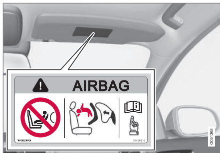
Alternativa 1: Localização do autocolante do airbag na protecção solar do lado do passageiro.
