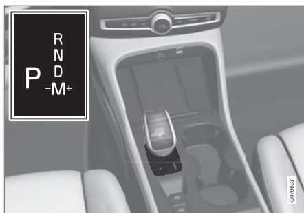
小型セレクトレバーおよびドライバーディスプレイのシフトパターンの概観
