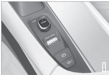
Disco de arranque na consola de túnel.
