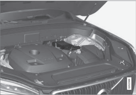
A bateria de apoio encontra-se numa caixa junto ao torção da roda.
