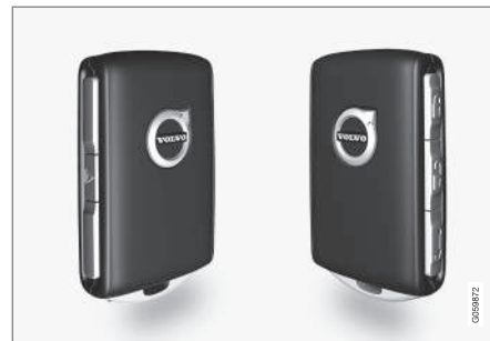
O comando à distância tem quatro botões - um no lado esquerdo e três no lado direito.
