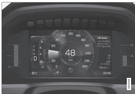
Mostrador do condutor 8 polegadas.
