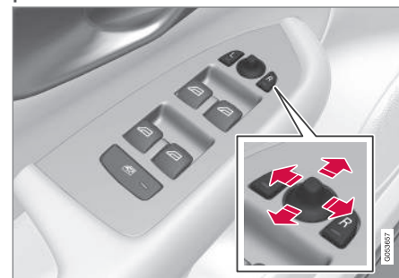
Controle dos espelhos das portas.
