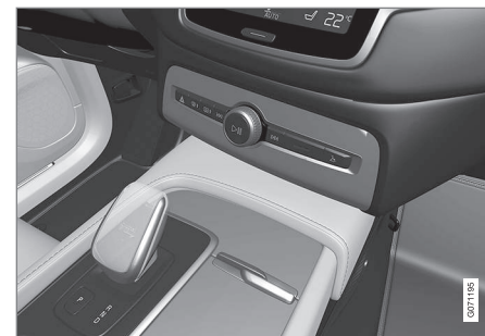
Visão geral da alavanca pequena de marchas em que não é possível desativar o inibidor do seletor de marchas.
