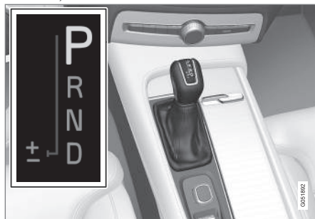
Visão geral da alavanca grande de marchas e do padrão de mudança de marcha no visor do motorista.
