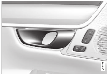
Åpningshåndtak for alternativ opplåsing av sidedør 15 .
