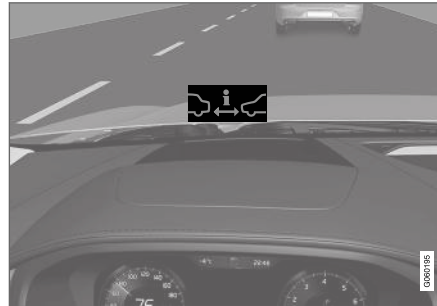
Symbol for Avstandsvarsel på frontruten 40 .
