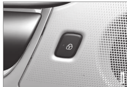
Knapp for låsing i bakdør med indikatorlampe.
