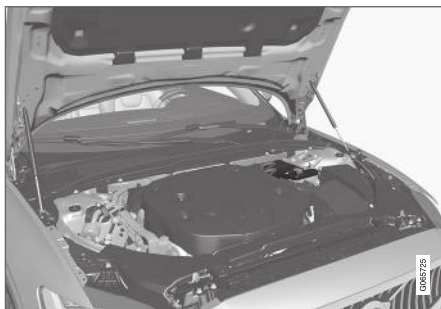
A segédakkumulátor a motortérben található.
