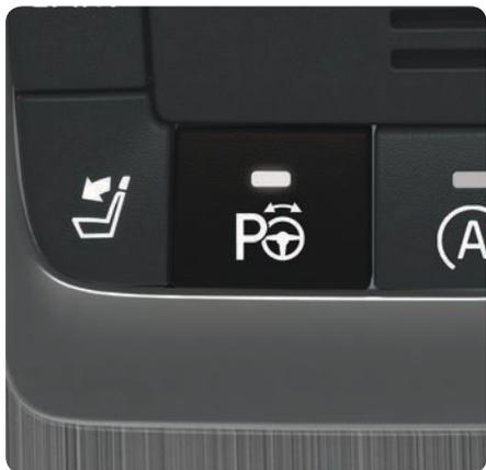
Система PAP проверяет наличие свободного пространства и затем направляет автомобиль в выбранное место. Задачи водителя - выбрать передачи, регулировать скорость и тормозить/останавливать автомобиль.
