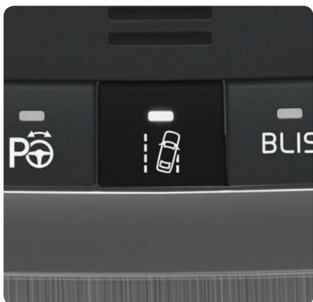
Если автомобиль движется так, что вот-вот пересечет боковую линию, система LKA активно противодействует этому, прикладывая небольшой крутящий момент к рулевому колесу. Если автомобиль пересекает боковую линию, система LKA предупреждает об этом водителя вибрацией рулевого колеса.
