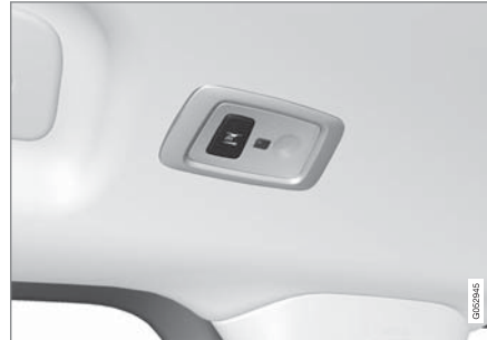
في السيارات المزودة بسقف بانوراما* توجد وحدات مصابيح واحدة في كل جهة من جهتي السقف.
