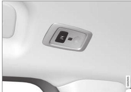
W samochodach z panoramicznym oknem dachowym* są dwa moduły lampek, po jednym z każdej strony sufitu. 7
