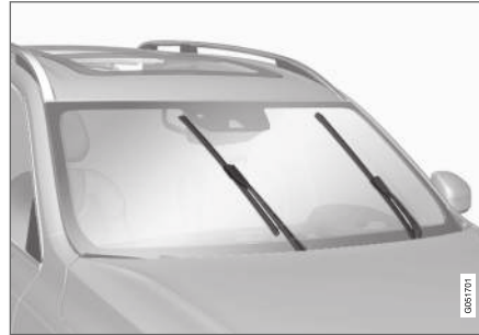
Pióra wycieraczek w pozycji serwisowej.
