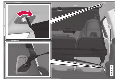
Zamocowanie w tylnych gniazdach.
