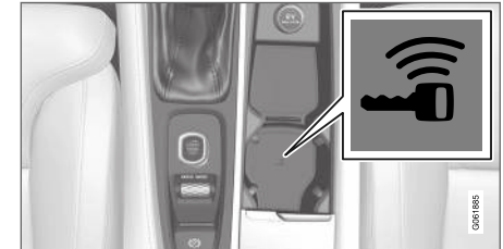
Lage des Schlüssellesegeräts in der Tunnelkonsole.
