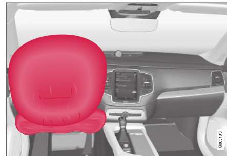
Lenkrad-Airbag und Knie-Airbag am Fahrersitz.
