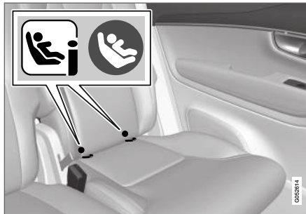
Lage der Befestigungspunkte in der zweiten Sitzreihe.
