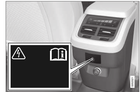
Steckdose in der Tunnelkonsole, zweite Sitzreihe.
