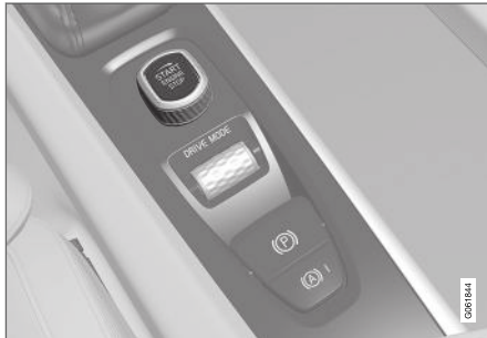
Startschalter auf der Tunnelkonsole.
