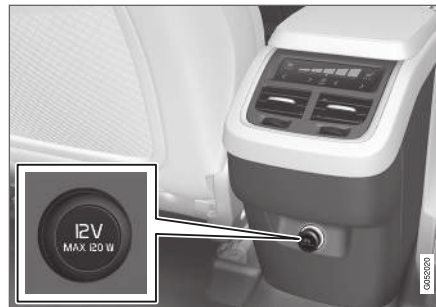
12-V-Steckdose in der Tunnelkonsole, zweite Sitzreihe.
