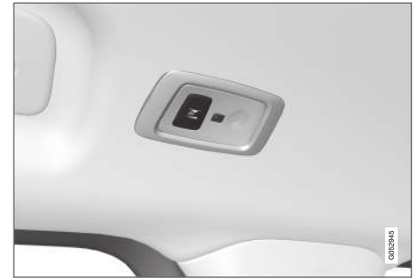
Fahrzeuge mit Panoramadach* verfügen beidseits des Dachs über je ein Leuchtenmodul. 10
