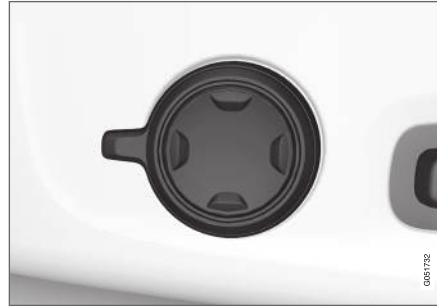
Seitlich am Sitzpolster angebrachter Multifunktionsschalter.
