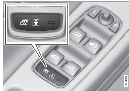
Panneau de commande porte conducteur.
