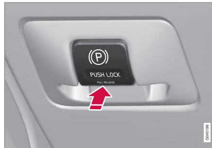
Commande de frein de stationnement - serrage.
