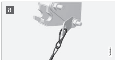
8 Câble de sécurité.
