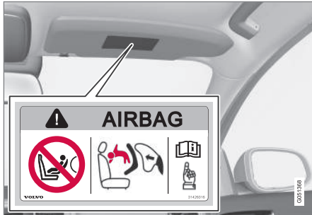
Alternative 1 : placement de l'autocollant de coussin gonflable sur le pare-soleil du côté passager
