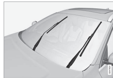
Balais d'essuie-glace en position d'entretien.
