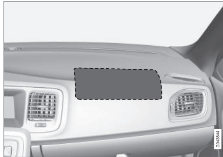
Emplacement du coussin gonflable (airbag) du côté passager dans les voitures à conduite à gauche.
