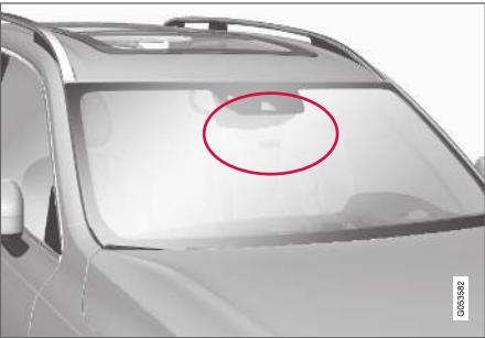
La zone marquée dans l'illustration doit être nettoyée régulièrement et exempte d'autocollants, d'objets, de film solaire, etc.
