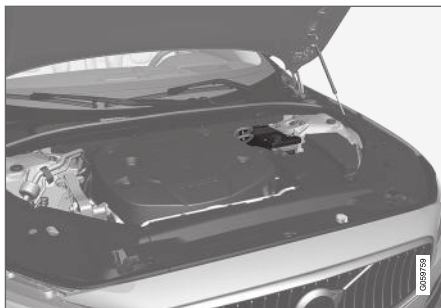
La batterie de démarrage se trouve dans un caisson, près de l'amortisseur, dans le compartiment moteur.
