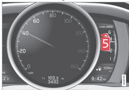
Indicateur de changement de vitesses dans un tableau de bord numérique* 6
