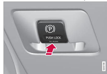
Commande du frein de stationnement
