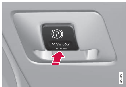
Commande du frein de stationnement
