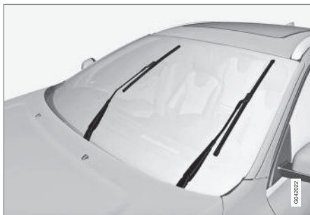
Balais d'essuie-glace en position d'entretien
