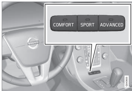
Réglages du châssis
