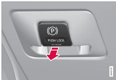
Commande du frein de stationnement
