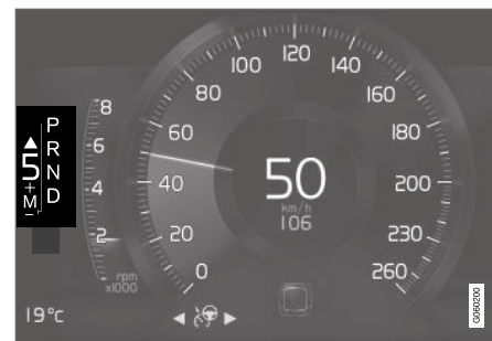
Wskaźnik zmiany biegu na 8-calowym wyświetlaczu kierowcy.
