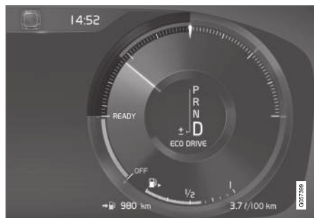
Wskaźnik ECO na 12-calowym wyświetlaczu kierowcy*.
