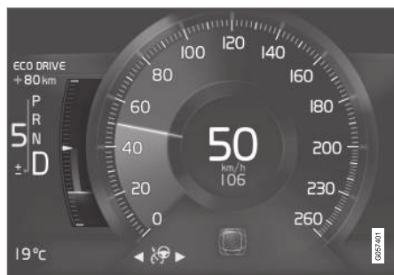
Wskaźnik ECO na 8-calowym wyświetlaczu kierowcy.
