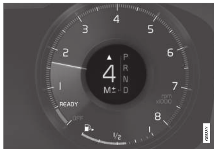
Wskaźnik zmiany biegu na 12-calowym wyświetlaczu kierowcy*.
