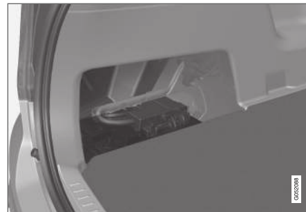
Akumulator rozruchowy znajduje się w przestrzeni bagażowej.
