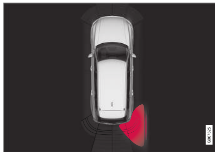
Podświetlona ikona funkcji CTA w polu graficznym Układ wspomagania parkowania na ekranie wyświetlacza.
