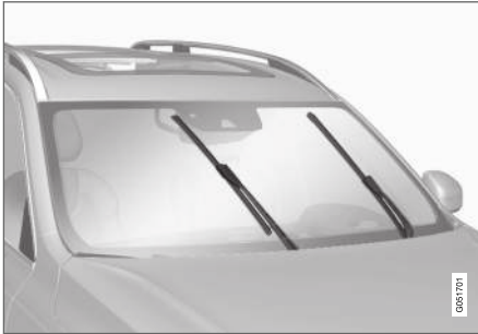
Pióra wycieraczek w pozycji serwisowej.
