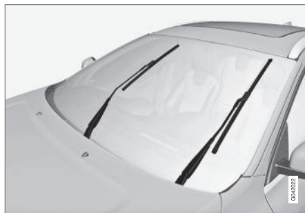
位於維修位置的雨刷片。
