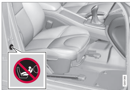
可能位置 2：乘客側門柱防護氣囊標籤位置。防護氣囊標籤可在開啟乘客車門時看到。
