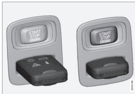
Contactslot met transpondersleutel uitgetrokken/ingeduwd.
