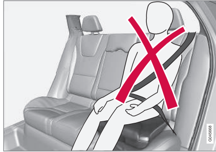
Verkeerde positie: de hoofdsteun moet even hoog afgesteld zijn als het hoofd en de gordel mag niet onder de schouder door lopen.
