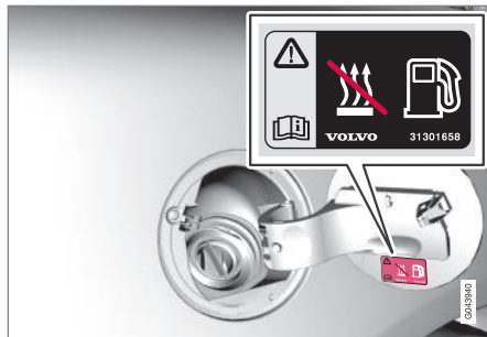
Waarschuwingsticker op tankvulklep.
