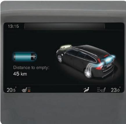
In **MY CAR** werden viele Funktionen des Fahrzeugs bedient, z. B. Einstellungen zu Uhr, Außenspiegeln und Verriegelung. Die Fahrtstatistik und der Leistungsfluss werden auch grafisch angezeigt. In der Normalansicht der Quelle **MY CAR** auf **OK/MENU** drücken und **Hybrid** auswählen:
