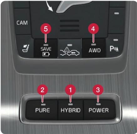
Das Fahrzeug wird von zwei Motoren angetrieben – einem Elektro- und einem Dieselmotor. Es können verschiedene Fahrmodi gewählt werden. Sie können keinen „falschen“ Fahrmodus wählen – wenn bestimmte Bedingungen nicht erfüllt sind, wechselt das Fahrzeug wieder in den HYBRID-Modus. In diesem Fall leuchtet die Lampe in der Hybrid-Taste auf.
