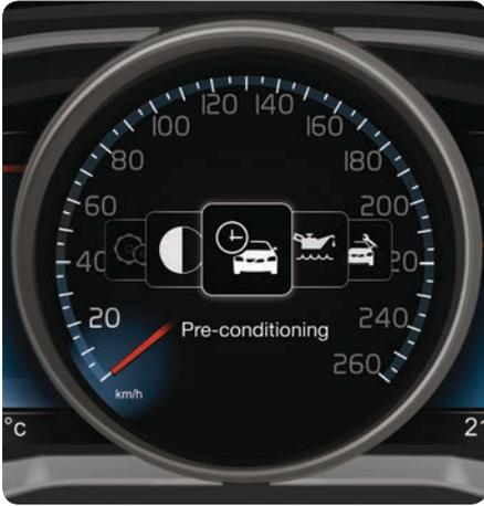
Die Vorklimatisierung dient dazu, vor einer geplanten Fahrt den Innenraum zu kühlen oder zu heizen und wird über die digitale Instrumentierung, den Transponderschlüssel\* oder die App Volvo On Call\* gestartet. Außerdem bereitet sie das elektrische Antriebssystem des Fahrzeugs optimal auf die Fahrt vor.
