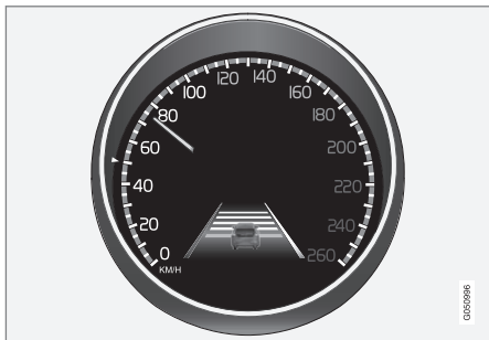
Linee laterali della funzione LDW.
