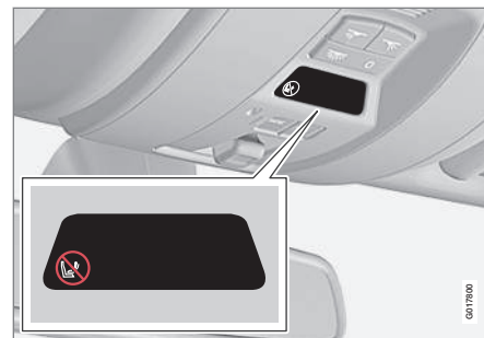
Indicazione dell'airbag lato passeggero attivato.
