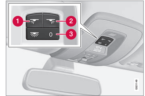
Comandi nella mensola del padiglione per le luci di lettura e l'illuminazione abitacolo anteriori.
