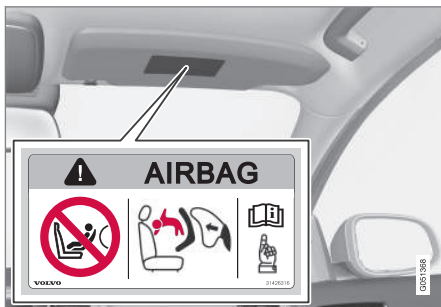
Vaihtoehto 1: Turvatyynyn tarran sijainti matkustajanpuoleisessa häikäisy-suojassa.
