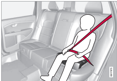
Oikea sijainti, vyö on asetettu olkapään päälle.
