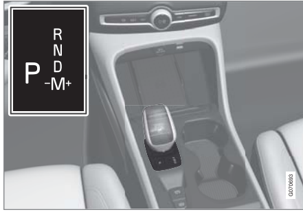
نظرة عامة على ذراع تغيير التروس الصغير ونمط تغيير التروس في شاشة السائق.
