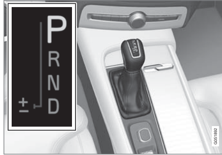
نظرة عامة على ذراع تغيير التروس الكبير ونمط تغيير التروس في شاشة السائق.
