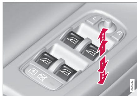
Regulering av vindusheiser.
