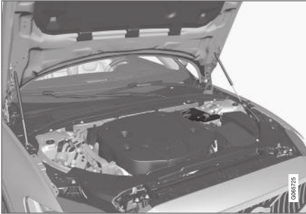
Støttebatteriet er placeret i motorrummet.
