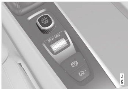
Startovací knoflík na tunelové konzole.
