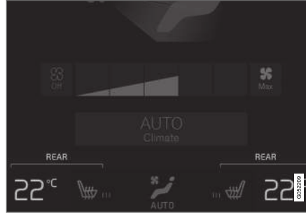
Klima görünümündeki Arka klima sekmesindeki sıcaklık düğmeleri.
