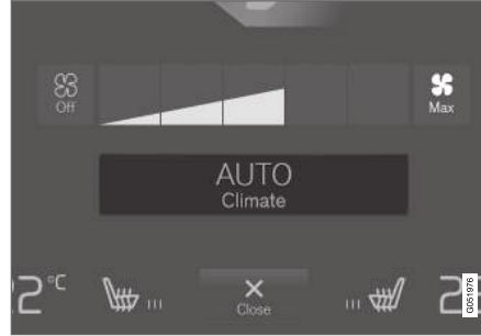
Klima görünümündeki otomatik düzenleme düğmesi.
