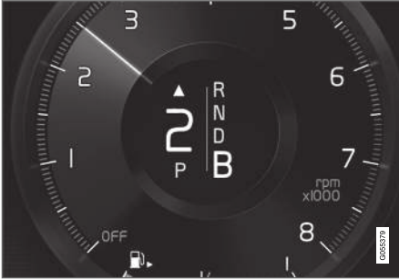
Sürücü gösterge ekranındaki vites değiştirme göstergesi 2 .
