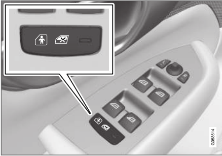
Elektrikli etkinleştirme ve devre dışı bırakma düğmesi.
