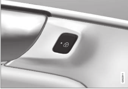
Arka kapıda gösterge lambalı kilit düğmesi.
