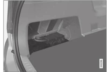
Marş motoru aküsü kargo alanında bulunur.
