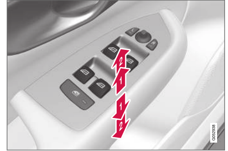
Elektrikli camların çalıştırılması.
