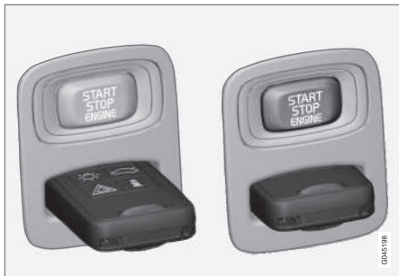
Вимикач запалення з витягненим/вставленим ключем ДК.
