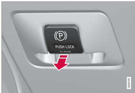
Ovládání parkovací brzdy - uvolnění.
