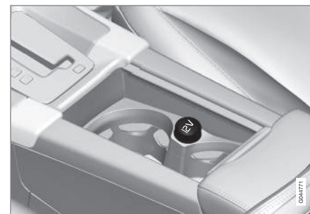
12 V-uttak i tunnellokonsoll, forsete.
