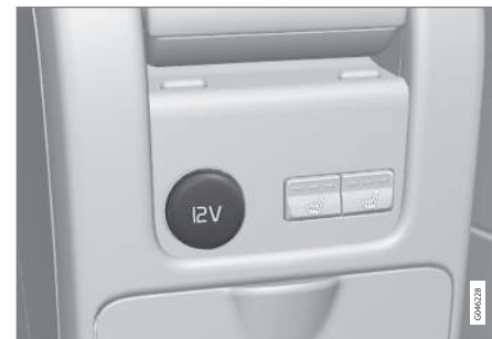
12 V-uttak i tunnellokonsoll, baksete.
