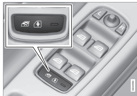
Painel de comando da porta do condutor.
