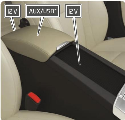
Pour que la prise 12 V de l'habitacle fonctionne, la télé-commande doit être en position **I**. La prise 12 V\* du coffre à bagages est quant à elle toujours activée.
