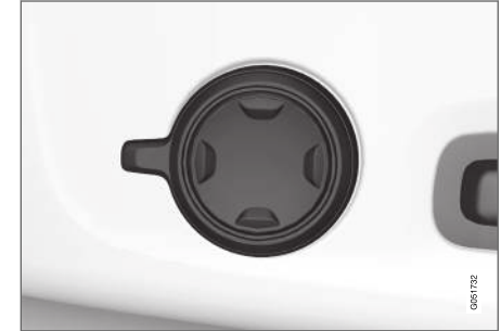
Multifunktionsreglaget, placerad på sidan av sätets siddel.
