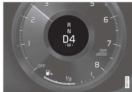
Kuljettajan näyttö vaihdettaessa ohjauspyörävalitsimilla, pieni vaihdevipu.
