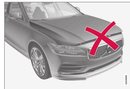
Cofano non completamente chiuso.
