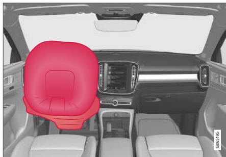
Airbag nel volante e airbag ginocchia<sup>1</sup> nel sedile anteriore sul lato conducente.
