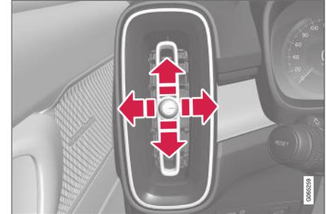
Leva della bocchetta di ventilazione<sup>3</sup>.
