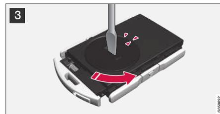
3 Servendosi ad esempio di un cacciavite, ruotare lo sportello della batteria in senso antiorario in modo che i segni siano allineati al testo **OPEN**.
