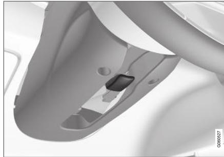
Leva per la regolazione del volante.
