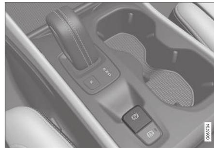
Quando il freno di stazionamento elettrocomandato è inserito, si sente un leggero rumore dal motorino elettrico. Lo stesso rumore si verifica anche in occasione dei test diagnostici automatici del freno di stazionamento.
