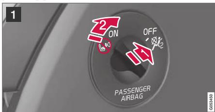
1 Estrarre il commutatore e ruotarlo da **ON** (A) a **OFF** (B).
