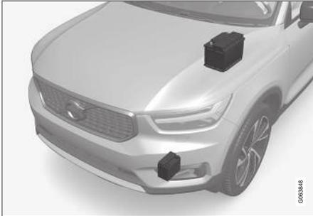
La batteria ausiliaria si trova nella parte inferiore del vano motore. Qui è illustrata anche la batteria di avviamento (sopra).
