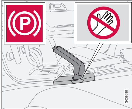
Warnsymbol im Armaturenbrett und Warnschild zur Klemmgefahr.
