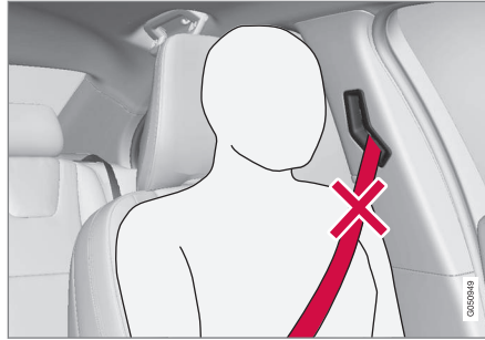
Nesprávně nastavený bezpečnostní pás. Pás musí doléhat na rameno.
