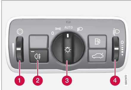
Übersicht Schalterfeld Beleuchtung.
