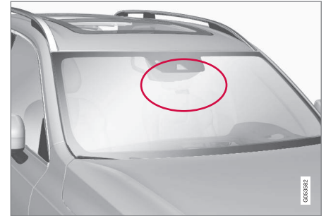
Umiejscowienie modułu radarowego.
