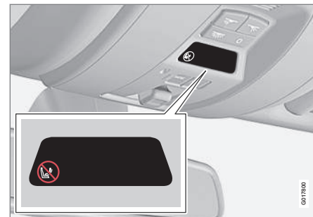
Az utaslégzsák aktivált állapotát mutató visszajelző.
