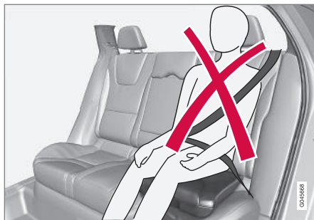
Helytelen elhelyezés, a fejtámlát a fejjel egyező magasságba kell állítani és a biztonsági öv nem lehet a váll alatt.
