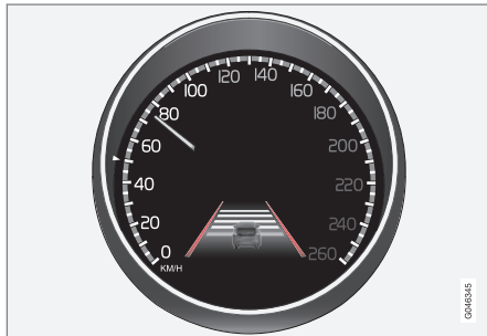
Zijlijnen van LDW-systeem (rood gemarkeerd op afbeelding).
