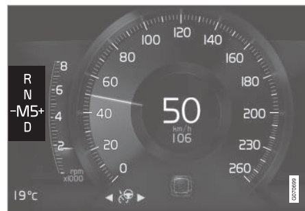
Schakelindicator op 8 inch bestuursdisplay voor de kleine schakelhendel.
