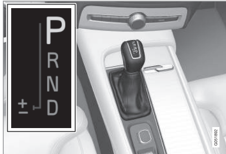
Overzicht voor de grote schakelhendel en het schakelpatroon op bestuurdersdisplay.
