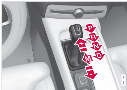
Overzicht grote schakelhendel en schakelstanden.
