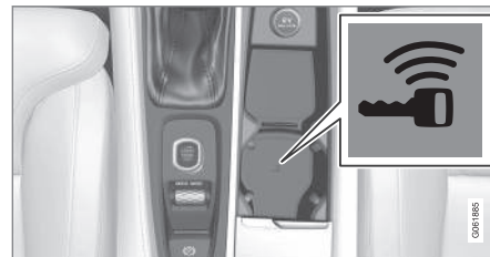
Positie back-uplezer in de tunnelconsole.
