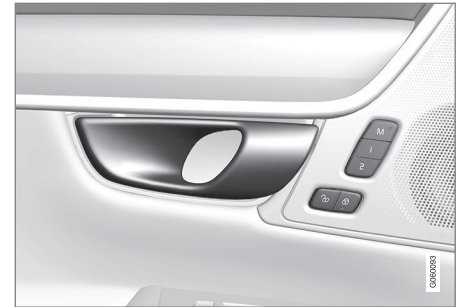
Openingsgreep voor alternatieve ontgrendeling op zijportier 10 .
