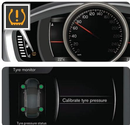
Después de cambiar los neumáticos o modificar la presión de neumáticos, debe realizarse siempre un calibrado. Si se enciende la luz (⚠) no es necesario controlar la presión de los neumáticos y el sistema se calibra. Proceda de la siguiente manera:
